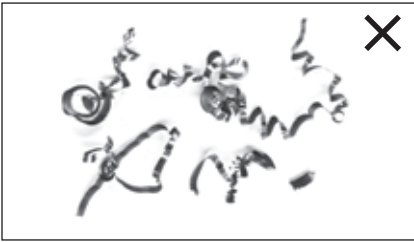
Elma kabuğu şeklinde talaş (Kıvrılma olmadan)
